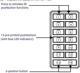
FIG. 4 MET-13E 13-BUTTON KEYPAD
