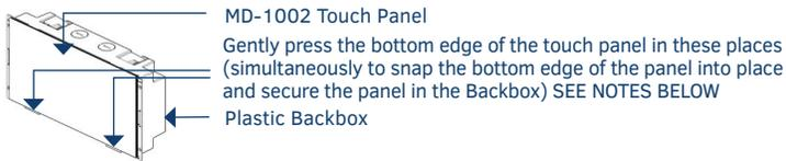
**FIG. 5** SNAPPING THE BOTTOM EDGE OF THE PANEL INTO THE BACKBOX
